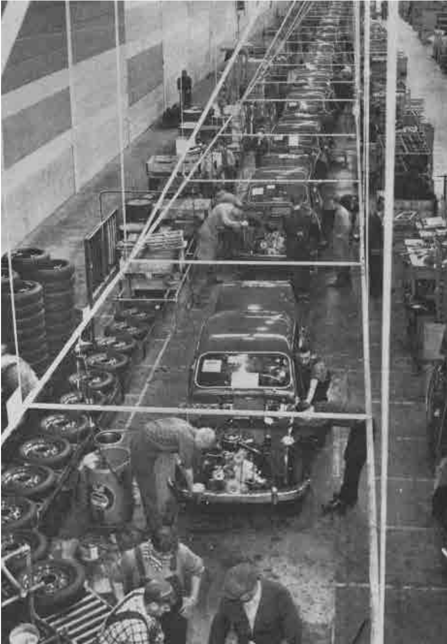
Slutmonteringen har cirka 40 stationer och en ny bil rullar av bandet var fjärde minut.
