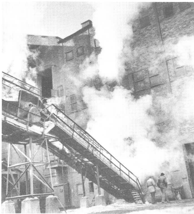
Transportband lastar den granulerade slaggen direkt på järnvägsvagn.
